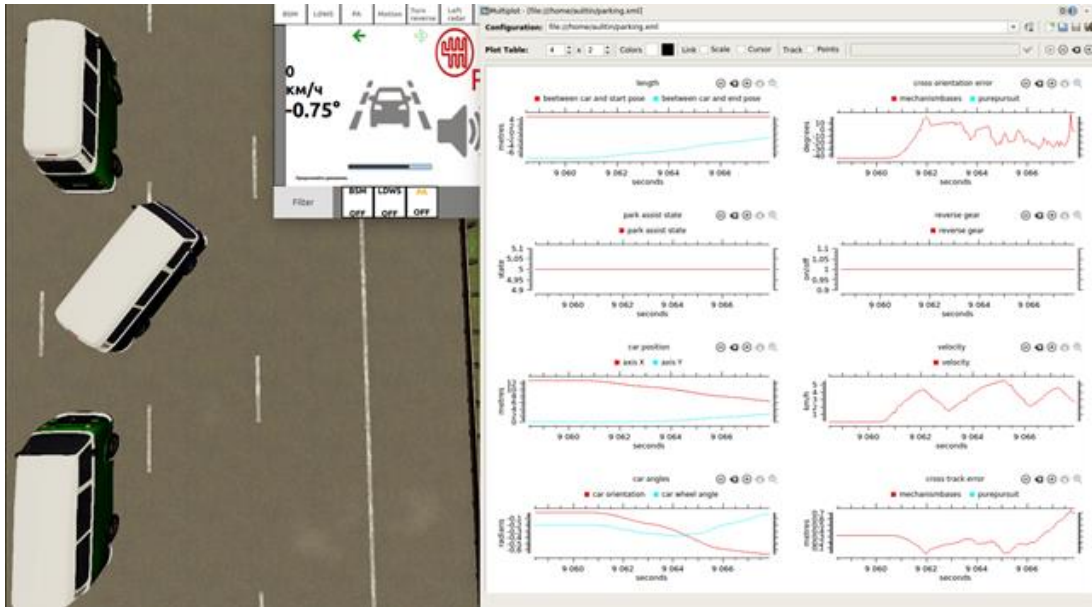
Рис 4. Испытания системы помощи водителю при парковке в симуляторе CARLA
