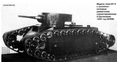
Танк Н. Циганова (БТ-5) с катково-гусеничным движителем (1935 г.)
