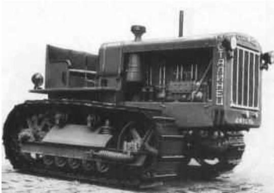
«С-60» - прототип американский трактор «Катерпиллер» (1932 г.)
