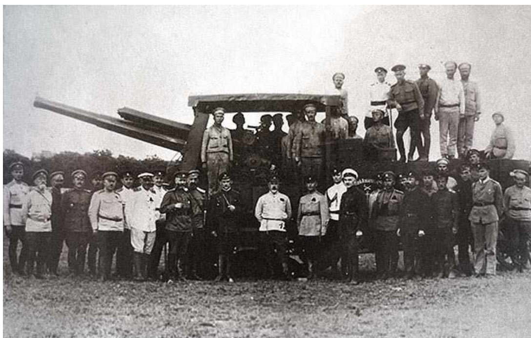
Рис. 28. 120-мм САУ на базе трактора «Буллок-Ломбард» («Bullock-Lombard») 6-го тракторного дивизиона Морской тяжелой артиллерии Донской армии Вооруженных Сил Юга-России, (1919 г.)
