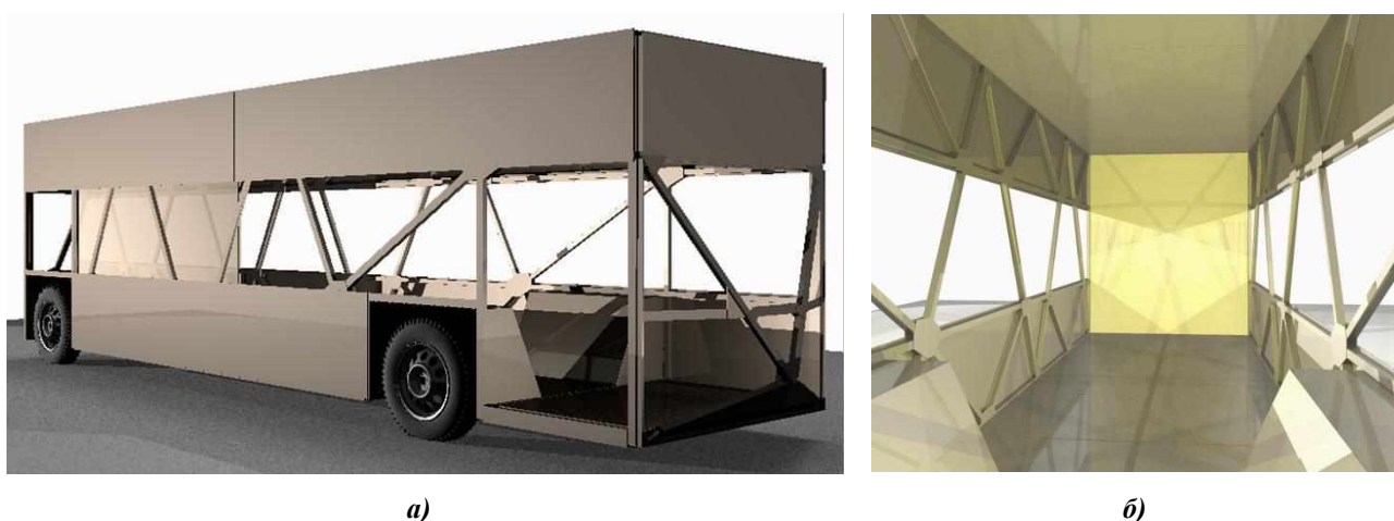
Рис. 1. Прототип кузова-монокока с основанием и крышей в виде трехслойных панелей: а – внешний вид; б – вид из передней части салона
