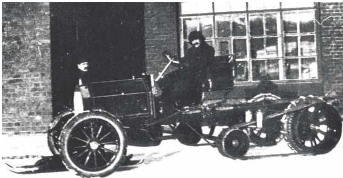
Рис. 35. Первая работа А. Кегресса, французская машина «ФЛ» с дополнительной осью и цепями (фотография снята у императорского гаража в Царском Селе, за рулем сам изобретатель 1906-1916 гг.)
