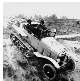
«P-7 bis» был выполнен на 20-сильном легковом шасси «В-10» (1927-1929 гг.)
