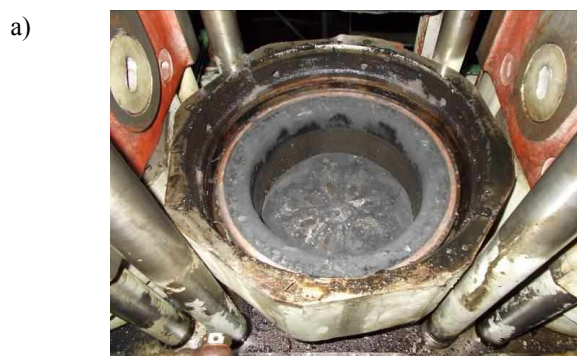
Рис. 7. Состояние деталей цилиндропоршневой группы двигателя 8ЧН 22/28 с базовым (а) и оптимизированным (б) рабочими процессами
