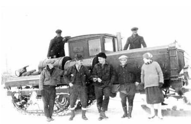
Рис. 30. Аналогичные полугусеничные снегоходы начала XX в. с паровой машиной и двигателем внутреннего сгорания
