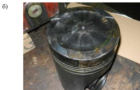
Рис. 7. Состояние деталей цилиндропоршневой группы двигателя 8ЧН 22/28 с базовым (а) и оптимизированным (б) рабочими процессами
